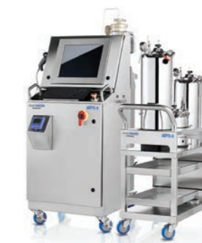
金胶粒子去除测试系统 (AGPTS) 为 Planova 过滤器提供了自动验证完整性测试。
